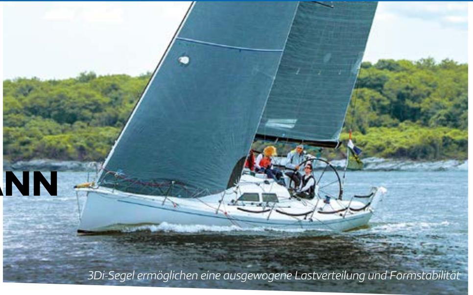
*3Di-Segel ermöglichen eine ausgewogene Lastverteilung und Formstabilität*
