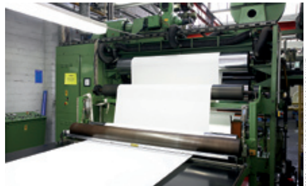
8. Das Polyestergewebe wird in einem mehrstufigen Prozess bearbeitet. Das Bild zeigt das Kalandern (Walzen)
