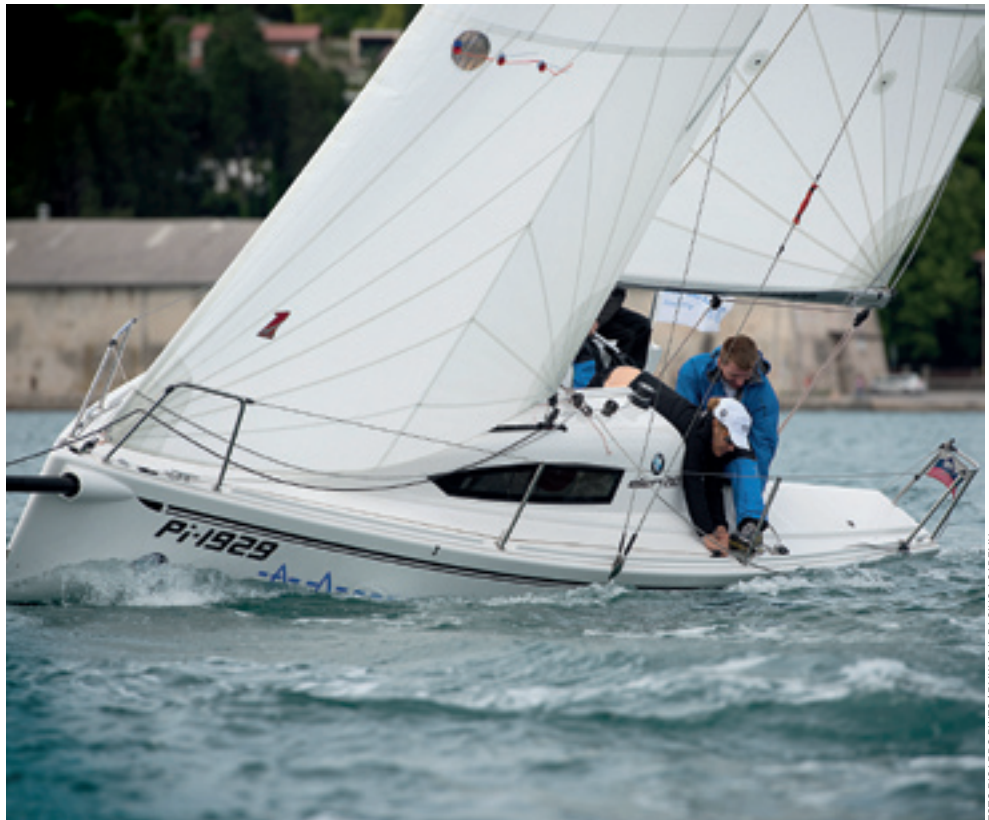
6. Segel aus hochwertigem Dacron im Radialschnitt, wie die OneSails-Garderobe dieser Elan 210, sind hinsichtlich Formstabilität eine Klasse für sich. Das garantiert mehr Vortrieb, weniger Krängung und bessere Höhe am Wind
