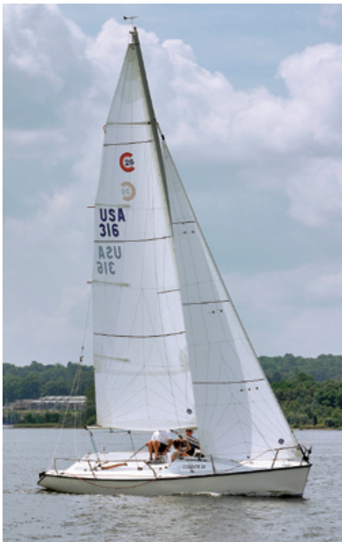
12. Diese Radial-Garnitur von North Sails bleibt länger formstabil als ein vergleichbares Segel aus herkömmlichem Dacron. Die absolute Lebensdauer ist nochmals um ein Vielfaches höher
