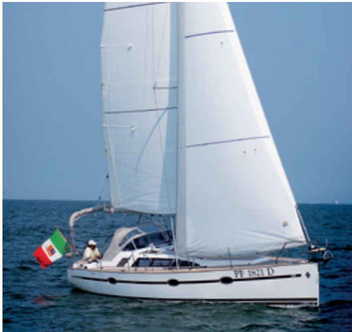
10. Horizontalschnitt ist für ein Großsegel durchaus in Ordnung
