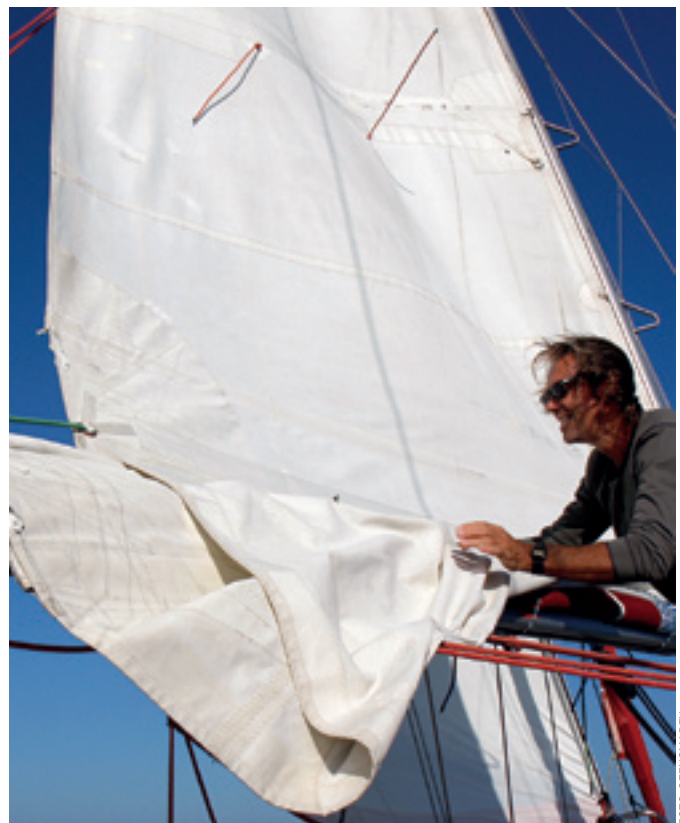
1. Das Doyle-Raudaschl-Groß der Seenomaden hatte 65.000 Seemeilen und acht Jahre am Buckel, ehe es nach einem Bedienungsfehler beim Vorwind-Reffen den Geist aufgab
